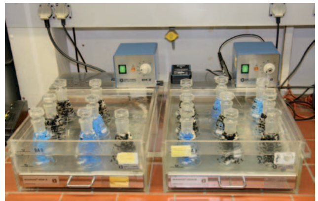
Fig. 6 PE-Granulate bei der 4-h-Kurzzeitprüfung im Wasserbad bei 30° C. Zur PE-Rohrherstellung wird PE-Granulat im Extruder aufgeschmolzen. Bei korrekter Verarbeitung und Verwendung von einwandfreiem PE-Granulat sollten hygienisch einwandfreie Rohre produziert werden. Als wichtige Qualitätssicherungsmaßnahme in der Praxis wird daher das Granulat regelmässig überprüft
