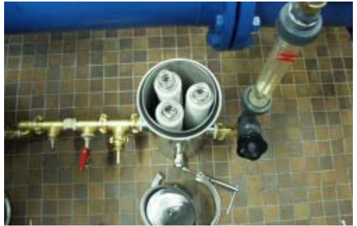
Bild 2: Feinfilterversuchsanlage, geöffnet, mit Kartuschen
