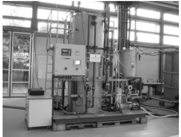
Bild: Kleintechnische Membranversuchsanlage zur Abtrennung von Algenzellen
