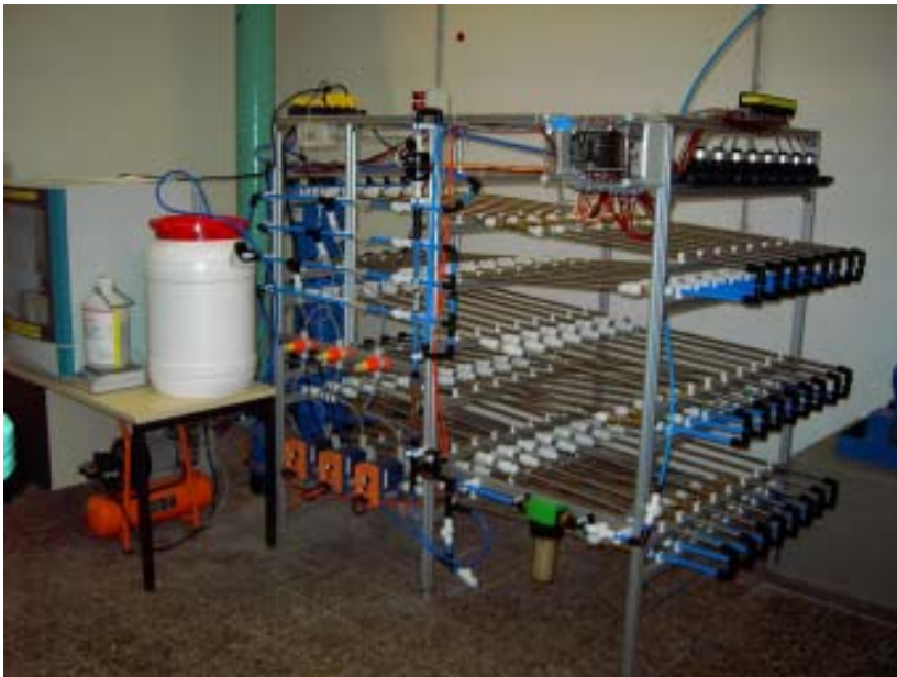
Versuchsanlage zur Durchführung der Korrosionsuntersuchungen zur Werkstoffbeständigkeit
