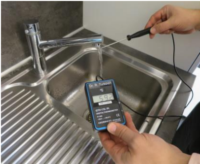
Temperaturmessung an einer Trinkwasser-Entnahmestelle
