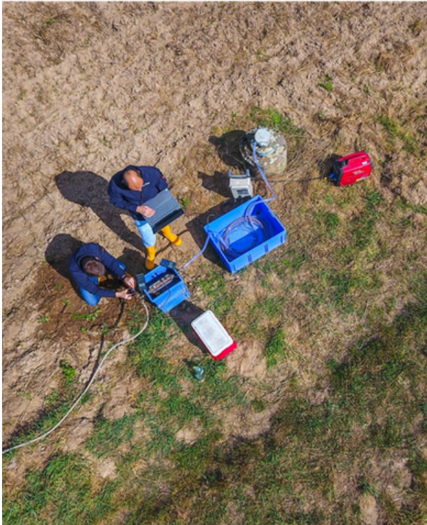
Abbildung 7: Durchführung einer Grundwasserprobenahme an einer landwirtschaftlich geprägten Messstelle.
