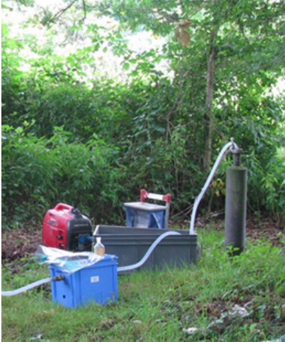
Abbildung 1: Eine Grundwassermessstelle an der eine Probe zur Untersuchung der Nitratkonzentration entnommen wird.
