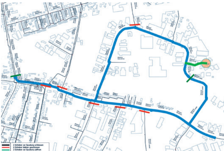
Abb. 3: Im zweiten Schritt der Spülplanung werden detaillierte Schieberpläne für die einzelnen Spülstrecken erstellt. In Grün ist die zu spülende Strecke dargestellt, bereits gespülte Netzsegmente sind in Blau hervorgehoben. Der Spülhydrant ist mit einem orangen Kreis markiert. Relevante Schieber sind durch Linien markiert, wobei ihre Zustände farblich codiert sind: Zu öffnende Schieber sind in Grün dargestellt, zu schließende in Schwarz (in der Abbildung nicht enthalten). Schieber, die in vorherigen Spülungen geschlossen wurden und geschlossen bleiben, sind in Rot dargestellt.
