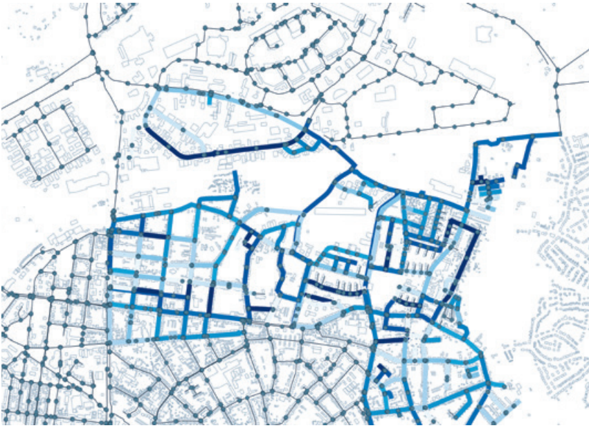
Abb. 2: Im ersten Schritt der Spülplanung wird das Netz in einzelne Spülabschnitte (in Blaustufen dargestellt) unterteilt.
