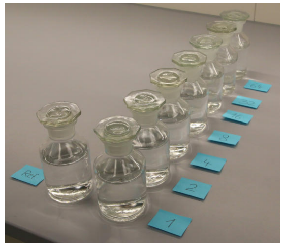
Verdünnungsreihe zur TON-Bestimmung im Prüflabor
